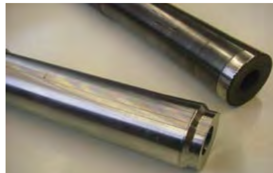
➤ Rohling des Schmiedestanzstempels mit abgedrehter Zone für den Auftrag des Hartmetalls (links) und (rechts) mit Hartmetall beschichtetes, endgeschliffenes Werkzeug nach dem Einsatz mit verlängerter Standzeit
