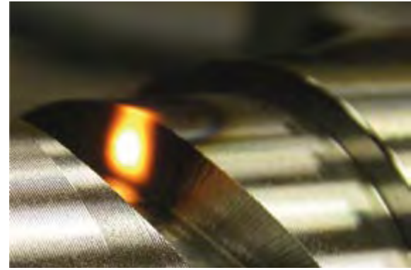
↑ Laserhärten einer Schallnutwand an einem Camtronic-Nockenstück
