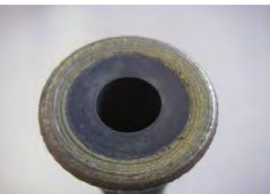
Laserauftraggeschweißte verschleißhemmende Hartmetallschicht im Schneidbereich eines Schmiedestanzstempels
