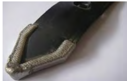
➤ Agrarzinken mit durch Laserauftragsschweißen mit Hartmetall beschichteten Schneiden
