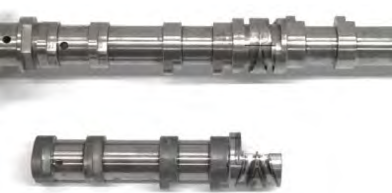
↑ Oben: Aus zwei Nockenstücken zusammengebaute Camtronic-Nockenwelle Unten: Nockenstück direkt nach dem Laserhärten
