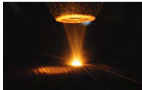
➤ Laserpulverauftragsschweißen einer verschleißhemmenden, hartmetallähnlichen Funktionsschicht mit einer coaxialen Ringspaltdüse
