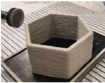
➤ Durch Fräs- und Bürstbearbeitung im frischen Zustand wird das Bearbeitungswerkzeug geschont.
