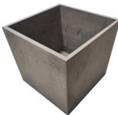
➤ Vereinfachter Demonstrator für Vorversuche zum Ausschalen ohne Entformungsschrägen
