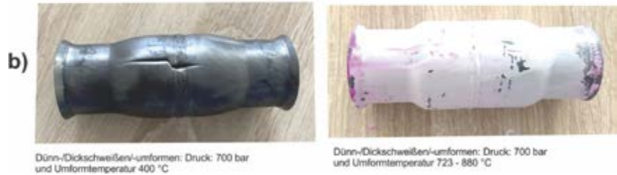
➔ Eigenschaftscharakterisierung geschweißter/umgeformter Bauteilstrukturen im Schweißnaht- und WEZ-Bereich: a) Nachweis erzielbarer Festigkeiten geschweißter/umgeformter Bauteilstrukturen, b) Rot-Weiß-Test zum Nachweis rissfreier Bauteilstrukturen
