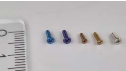
➤ Miniaturschrauben mit verschiedenen Schichtdicken einer ALD-Metalloxidschicht, die rechte Schraube ist unbeschichtet.
