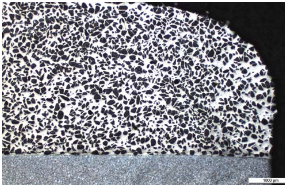
↳ Mit Laser aufgeschweißtes Hartmetall (Schliff)
