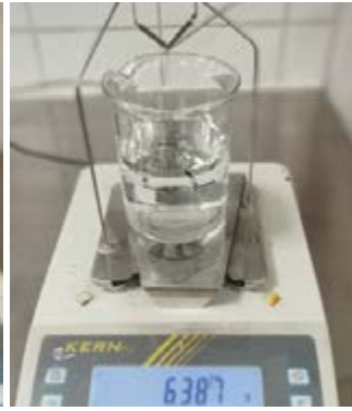
↑ Bestimmung der Rohdichte der Wälzschlacke
