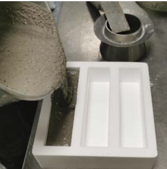
↑ Herstellung von Probekörpern mit alkalisch aktivierter Wälzschlacke
