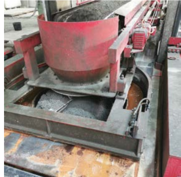
↑ Herstellung eines Schachtunterteils mit alkalisch aktivierter Schlacke
