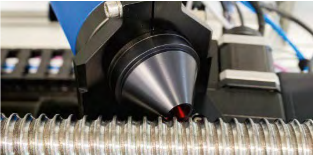
Welligkeitsmessung eines Kugelgewindetriebs
