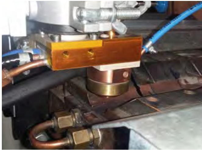
Entwickeltes Beschichtungssystem: Plasma-Pulver-Spritzbrenner mit seiner Hardwaretechnik und Pulverförderergerät für die Beschichtung von Bauteiloberflächen mit sehr feinen Pulverstrukturen
