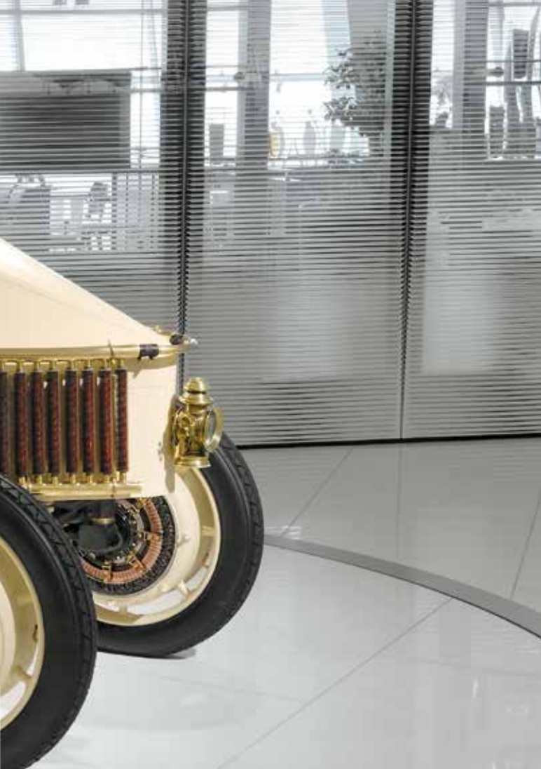
Abb.: Lohner-Porsche mit zwei Radnabenmotoren © Dr.-Ing. h.c. F. Porsche AG
