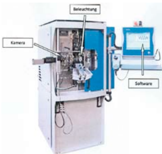
CNC-gesteuerte Federwindmaschine FUL25 mit Bildverarbeitungssystem
