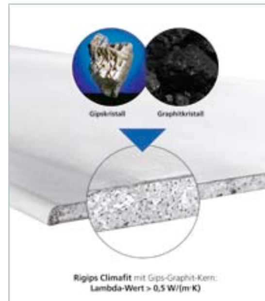
Schematische Darstellung der graphitmodifizierten Gipskartonplatte
