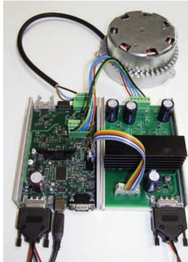
Steuergerät für BLDC-Motoren mit Steuerplatine (links) und Leistungsplatine (rechts)
