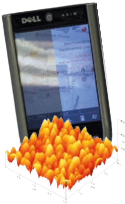
Nicht entspiegeltes Display (links) und mit Mottenaugenstrukturen entspiegeltes Display (rechts). AFM-Aufnahme einer Mottenaugenstruktur (im Vordergrund).
