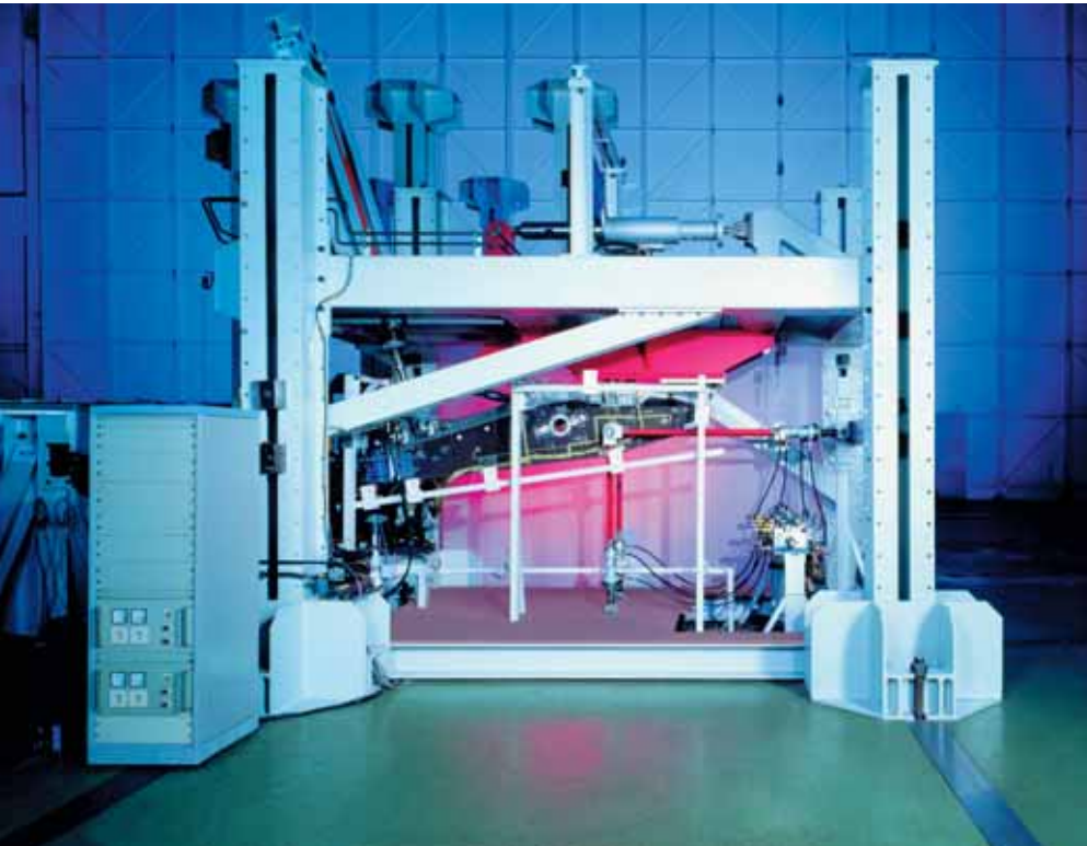
Ein Tragflächenbauteil („Flap Track“) beim Ermüdungstest
