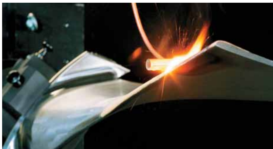
Randschichtlösungsgeglühen mit dem Laserstrahl
