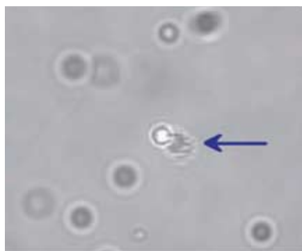
Optische Pinzette: Kunststoffkügelchen („beads“) werden im Lichtfeld des Lasers zum Fokus hin getrieben und dort festgehalten (links und Mitte). Es ist möglich, Proteine und andere Strukturen an diesen Beads zu befestigen (hier z.B. ein Aktinfilament, s. Pfeile), sie dienen dann als Kraftüberträger.
