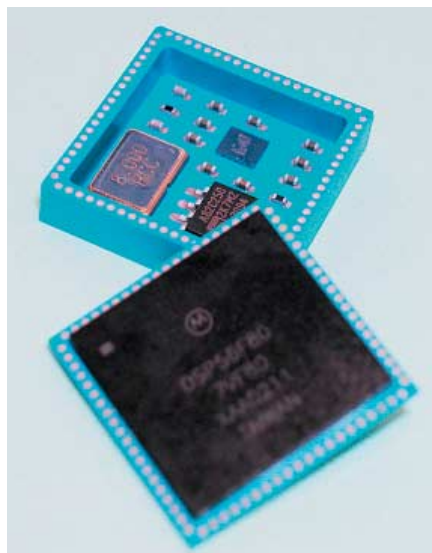
Peripheriemodul mit einer Kantenlänge von 17,5 mm (FhG IZM, Berlin).
