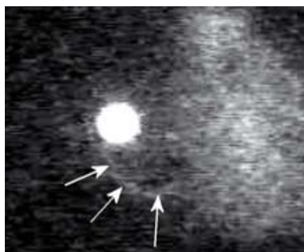
Optische Pinzette: Kunststoffkügelchen („beads“) werden im Lichtfeld des Lasers zum Fokus hin getrieben und dort festgehalten (links und Mitte). Es ist möglich, Proteine und andere Strukturen an diesen Beads zu befestigen (hier z.B. ein Aktinfilament, s. Pfeile), sie dienen dann als Kraftüberträger.
