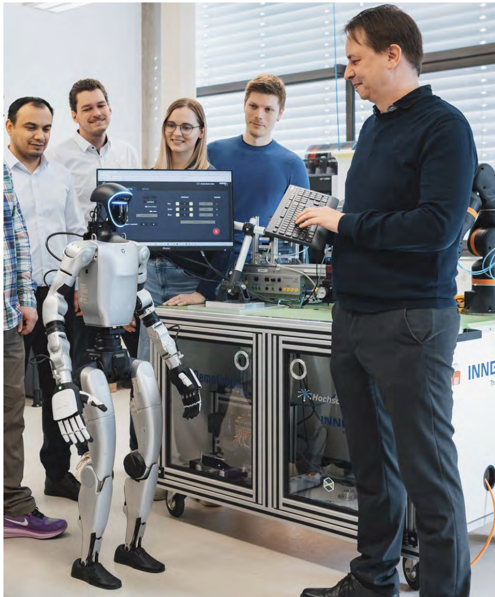
↑ Im Labor der Hochschule Aalen wird erprobt, wie die in NVIDIA Isaac trainierten Bewegungsstrategien auf einen realen humanoiden Roboter übertragen werden. © Hochschule Aalen, Jan Walford
