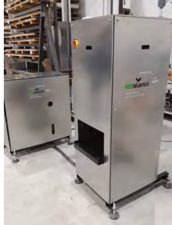
➔ Mobile Inserma-Station zur Vorverarbeitung von HDDs
