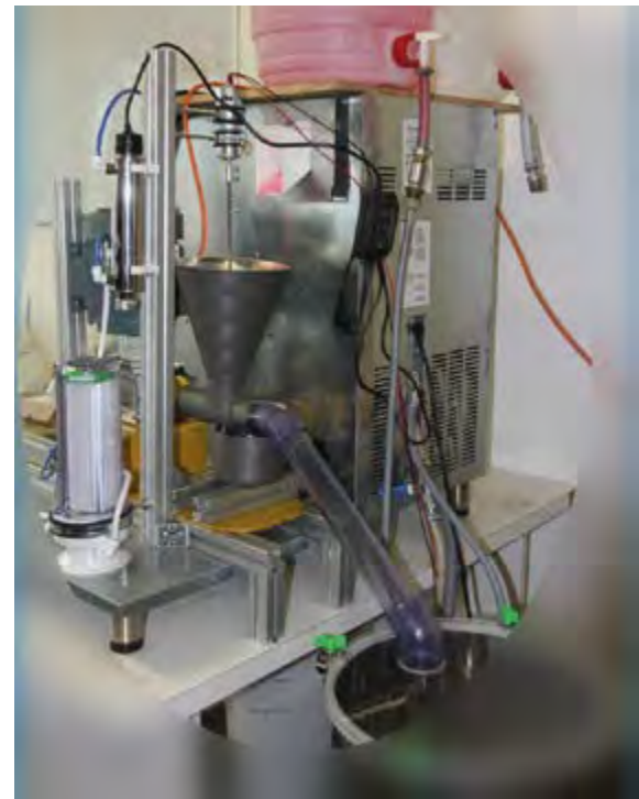
➤ FreeDeWaTER: Laboranlage, die automatisiert verunreinigtes Wasser kristallisiert, mechanisch trennt und das erhaltene Trinkwasser nachbereitet (Filter, UV-Bestrahlung) © FreeDeWaTER
