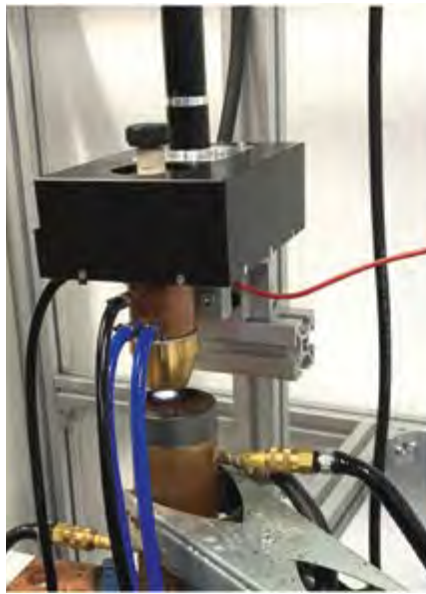
Aufgebauter Brennerprototyp des mechanisch-rotierenden Plasmalichtbogenschweißbrenners mit seiner Rotations- und Drahtfördereinheit und der Hardwaretechnik
