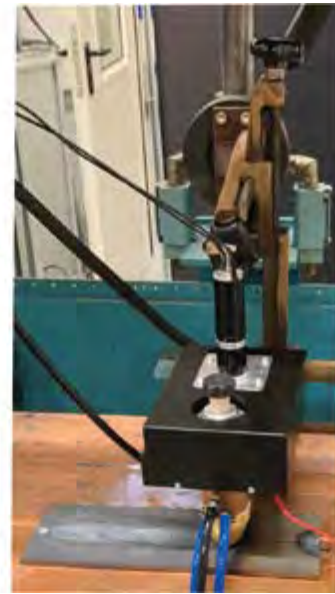
Aufgebauter Brennerprototyp des mechanisch-rotierenden Plasmalichtbogenschweißbrenners mit seiner Rotations- und Drahtfördereinheit und der Hardwaretechnik
