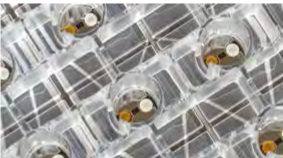
Ausschnitt aus der intelligenten Multiwellplatte: Reaktionskammern mit Sensoren
