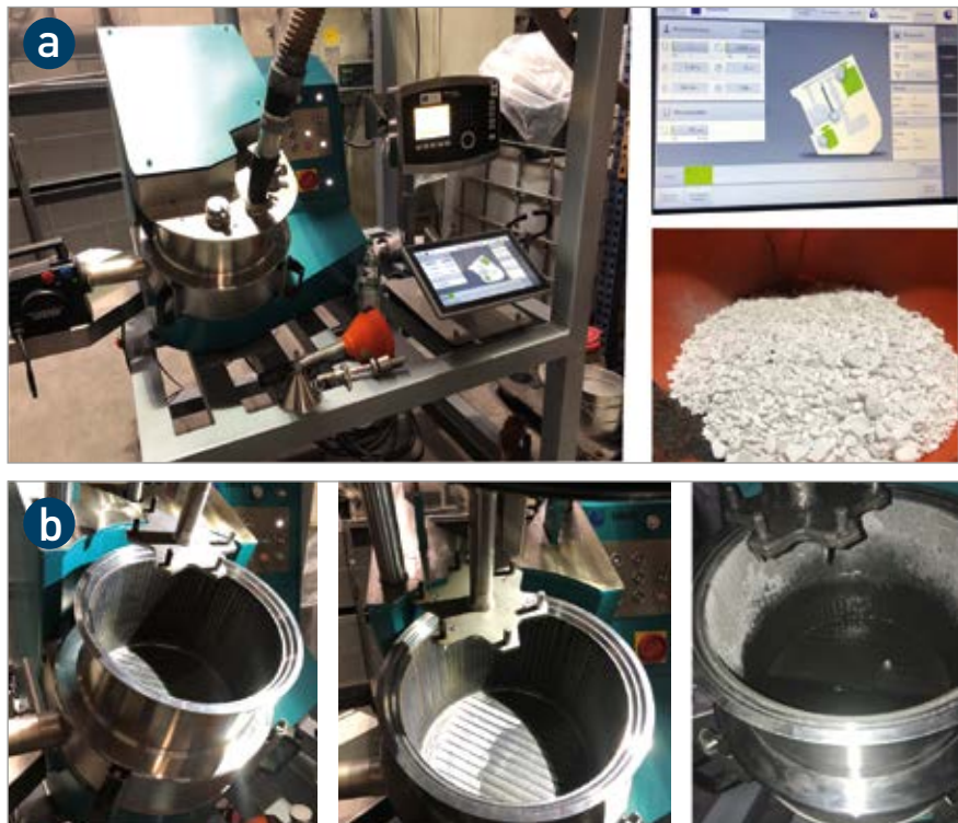
Entwickelte und aufgebaute Ein-Raum-Reaktor-Pilotanlage zur Herstellung von Schweißpulvern für das Aluminium-Unterpulver-Schweißen: a) Gesamtpilotanlage im Betrieb, b) Pilotanlage nach den durchgeführten Evaluierungsversuchen
