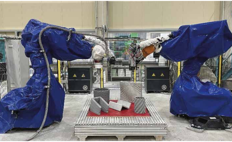
➤ Robo-Arena zur Extrusion und Fräsbearbeitung von Betonelementen
