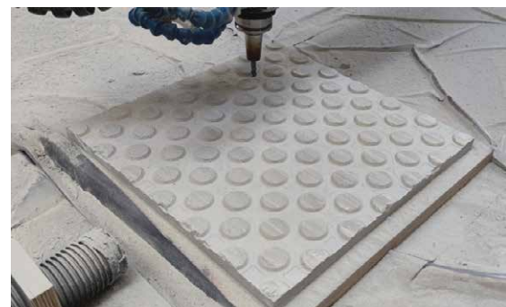
➤ Finale Fräsbearbeitung des extrudierten Betons
